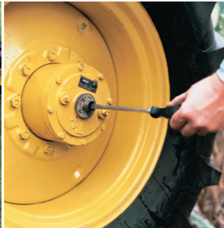
A sebességváltók "szabadonfutó" módban kapcsolható.
