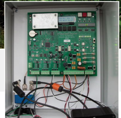
A T-L öntözőberendezésben a GPS irányító doboz/panel
