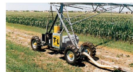
Középponti, vagy végponti csatlakozású tömlős lineár (beásott vezetékkel vagy földfelszíni kábeles irányítással)
