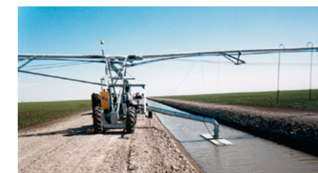
Középponti, vagy végponti táplálású árok vontató (beásott vezetékkel vagy földfelszíni kábeles irányítással)
