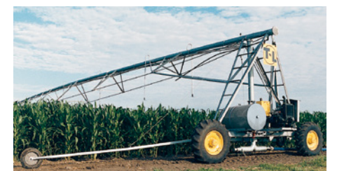
Egytámaszú lineár rendszer (tömlővel és barázdavezetéssel)
